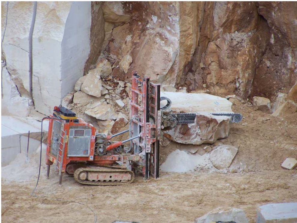
Figure 10 : Vue d'une des haveuses-rouilleuses utilisée pour la découpe des blocs
