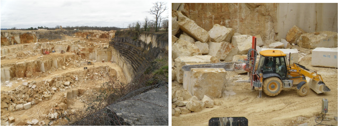
Figure 5 : Vues sur la fosse d'extraction et la découpe de bloc à la rouilleuse
